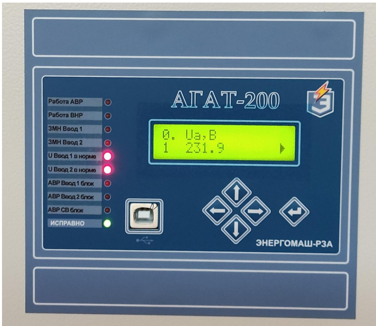
Рис. 7. Лицевая панель устройства АГАТ-200.В
