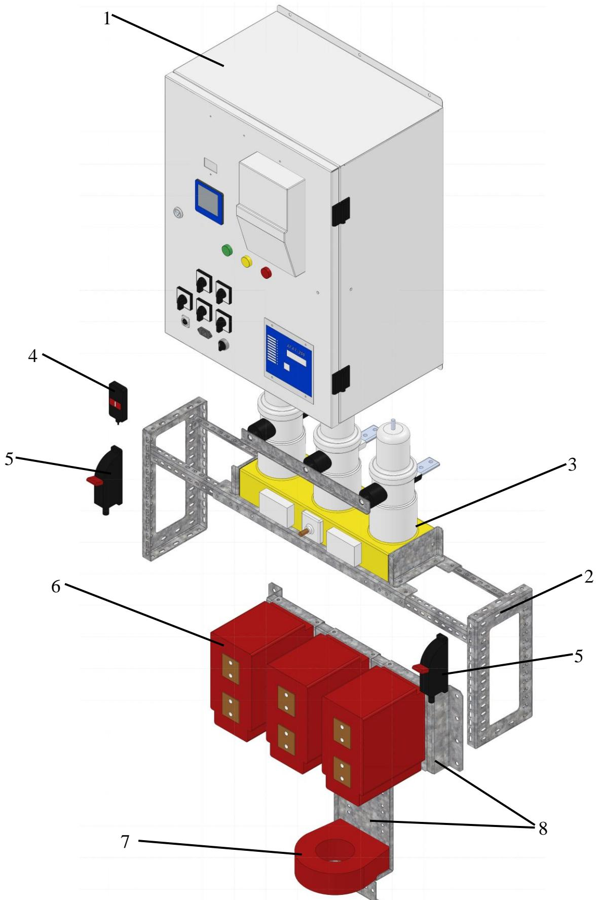
**Рис. 1. Основные функциональные элементы комплекта адаптации КСО**
