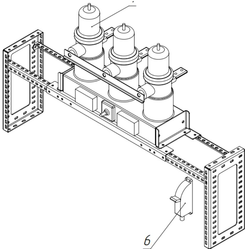
**Рис. 14. Соединение рамы адаптации и вакуумного выключателя**
