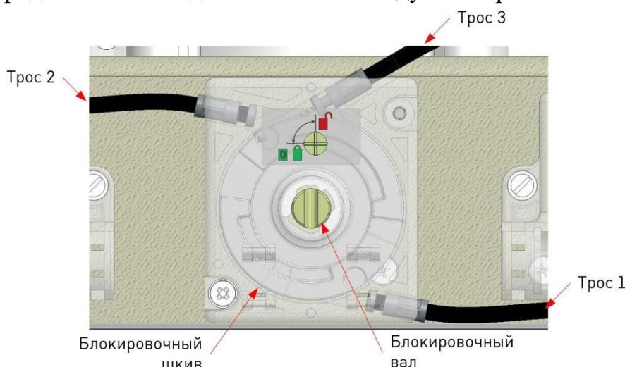
**Рис. 5.1. Блокировочный интерфейс**
