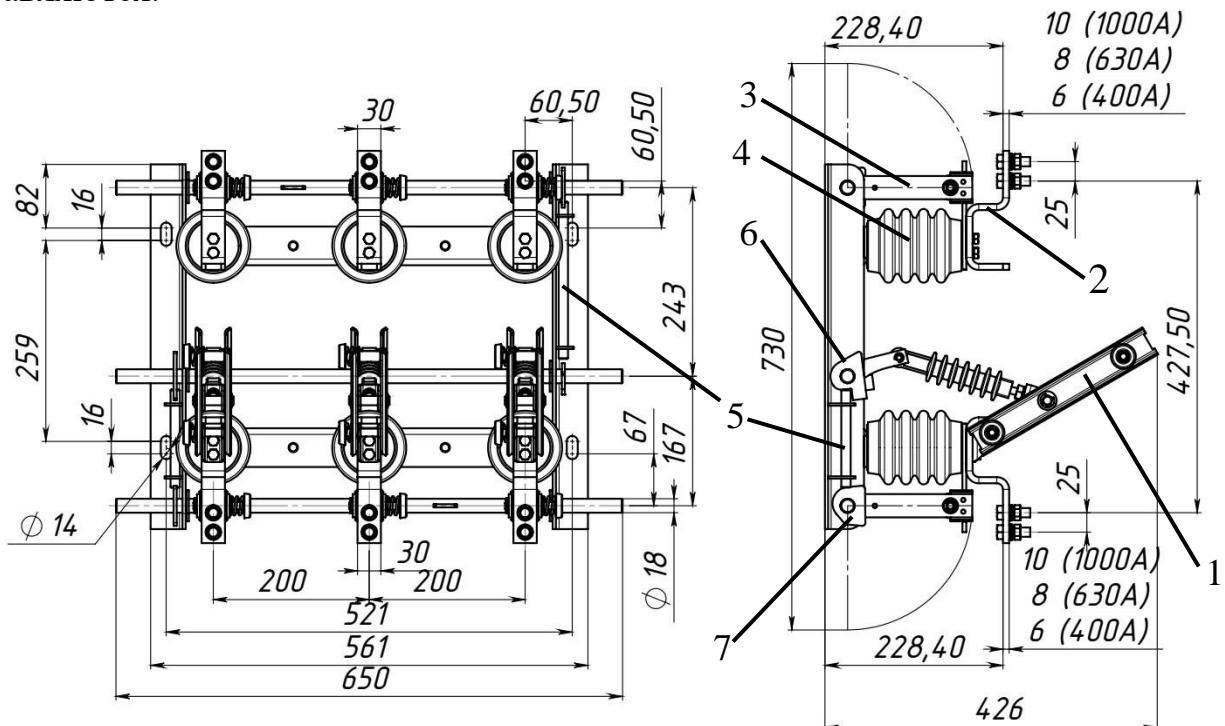
**Рис. 6. Конструкция разъединителя РВ3-10**
