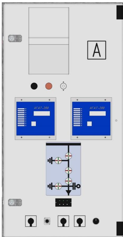
**Рис. 3. Дверь модуля вторичных цепей шкафа КСО**
