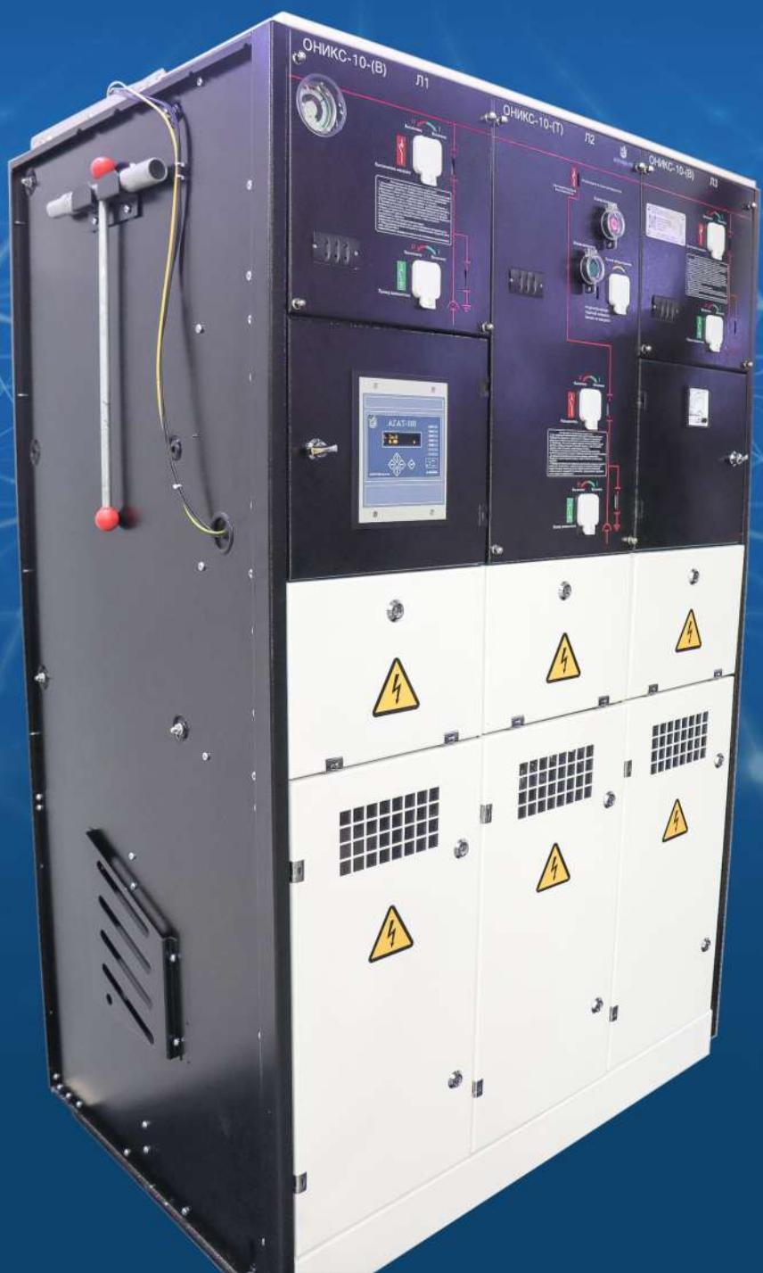
**Распределительное устройство КРУЭ «Оникс» с изоляцией газом SF6 (гексафторид серы, элегаз) функционально предназначено для приема и распределения электроэнергии, устанавливается в радиальных, магистральных и петлевых распределительных сетях 10 – 20 кВ трехфазного переменного тока частотой 50 Гц, для присоединения, питания и защиты одного или двух распределительных трансформаторов мощностью до 3000 кВА.**
