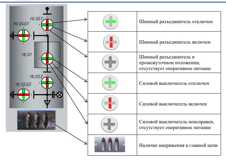
Рис. 4. Индикация на двери релейного отсека
