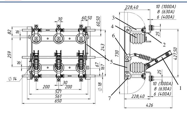
Рис. 6. Конструкция разъединителя РВЗ-10
