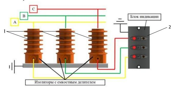
Рис. 7. Схема соединения блока индикации напряжения:
