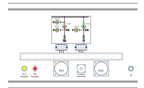
Рис. 11.1. Дверь релейного модуля шкафа КСО ячейки ТН-ТСН
