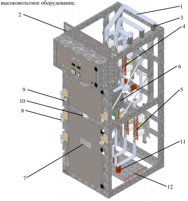
Рис. 12. Основные функциональные элементы шкафа КСО ячейки СР 10 кВ:
