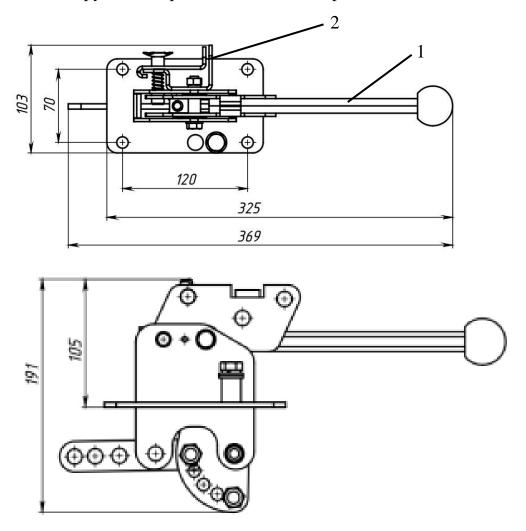
Рис. 6.2. Конструкция привода разъединителя ПР-10
