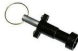
Ключ магнитный КМ-1 то же есть в комплекте. Он применяется для открывания замков электромагнитной блокировки ЗБ-1 без наличия напряжения в схеме ЭМБ. Его следует использовать на стадии монтажа и наладки оборудования КСО-298, но не в процессе эксплуатации.
