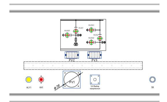
Рис. 12.1. Дверь релейного модуля шкафа КСО ячейки СР-ТН
