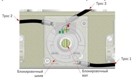
Рис. 5.1. Блокировочный интерфейс
