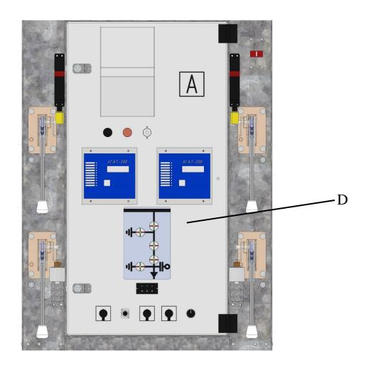
Рис. 3. Модуль вторичных цепей D шкафа КСО-298
