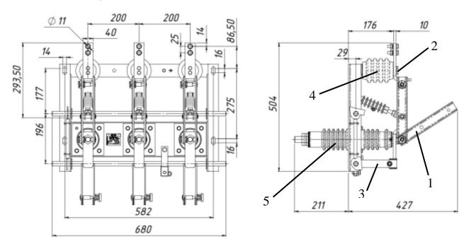
Рис. 6.1. Конструкция разъединителя РВФЗ-10
