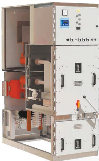
Комплектное распределительное устройство (КРУ) «Базальт» предназначено для распределения электрической энергии трехфазного переменного тока частотой 50 Гц, номинальным напряжением 6, 10 кВ в сетях с изолированной или заземленной нейтралью. Заземление нейтрали реализовано через дугогасящий реактор или резистор.
