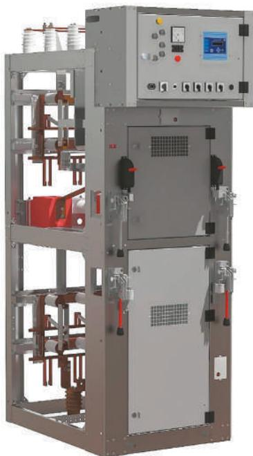
Камеры сборные одностороннего обслуживания серии КСО 298 предназначены для комплектования распределительных устройств (РУ) напряжением 6 или 10 кВ трехфазного переменного тока частотой 50 Гц в сетях с изолированной или заземленной через дугогасящий реактор или резистор нейтралью. Камеры и ячейки предназначены для размещения внутри зданий или в модульных блочных конструкциях.
