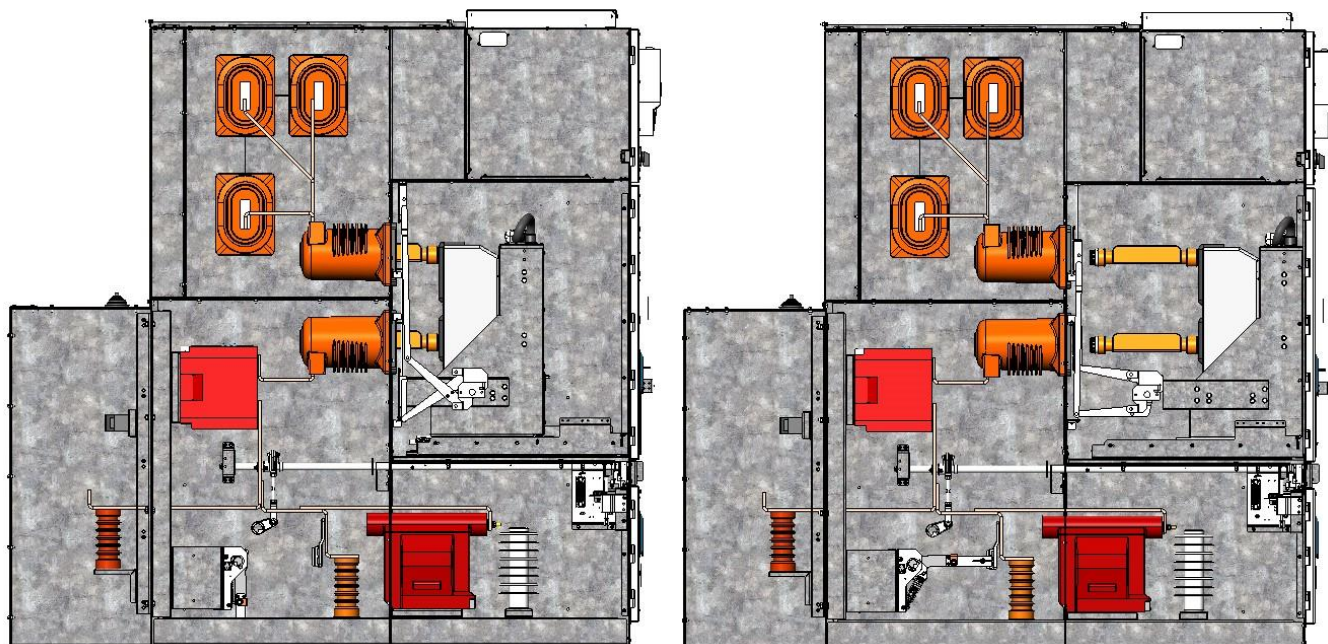
Рис. 6. Положения выкатных элементов на примере силового выключателя (слева – рабочее, справа – контрольное)
